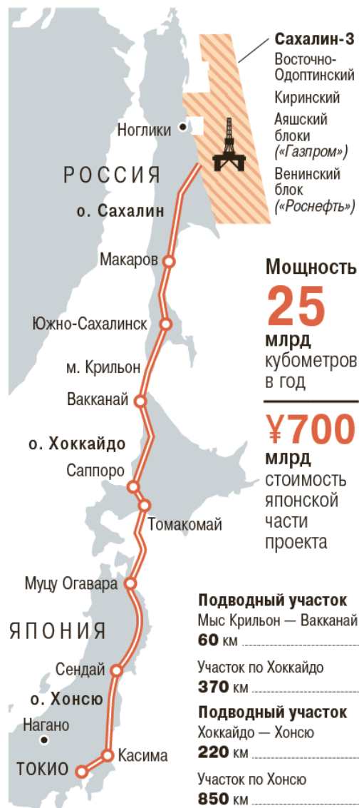
Рис. 1. Схема предполагаемого маршрута газопровода Сахалин-Хоккайдо-Токио. Источник: JPDO, JRNG
